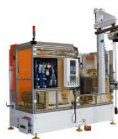
Soldador MFDC de 250KVA para motor DB-250-19006
