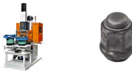
Soldadora por puntos MFDC de 330kVA para tuercas de automóvil
