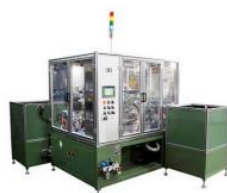
Máquina de soldar por resistencia con ocho estaciones con unidad de disparo magnética
