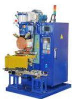
Soldadora de costura MFDC de 440KVA para aleta de enfriamiento del calentador de aceite FB-440-C18001
