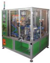
Soldador automático MFDC de 165KVA para soporte de relé DB-165-16032
