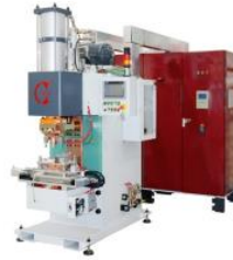
Soldadora de proyección por descarga de condensador de 30KJ para ajustador de ángulo de asiento de automóvil
