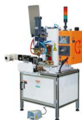
Soldadora CA de 25 KVA para bobina de estator de motor DN-25-19002
