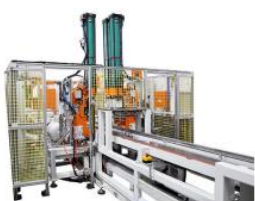
Remachadora 120T para el panel trasero de la lavadora ZMY-120-001-16001
