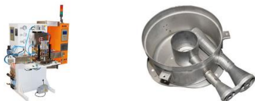
Soldadora MFDC 2x55KVA para piezas de aparatos de gas DB-110-18101
