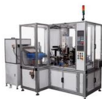
Soldador MFDC de 55KVA para soporte de enchufe DB-55-16106
