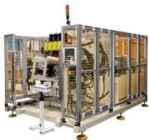
Remachadora 35T para revestimiento de lavavajillas y conjunto de refuerzo ZMY-035-001-17002
