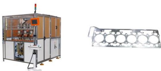
Soldadora automática MFDC 3x55KVA para juntas de culata de automóviles
