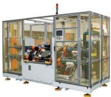
Remachadora 30T para el panel frontal de la lavadora ZMY-030-001-19001
