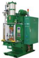
Soldadora por puntos/prensa CD 35000J para alimentación de compresor DR-35000-19003
