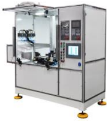
Soldadora por puntos MFDC de 300kVA para panel lateral de asiento de automóvil
