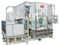
Soldadora de proyección por descarga de condensador de 40KJ para ajustador de ángulo de asiento de automóvil
