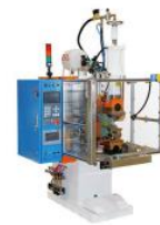
Soldador MFDC de 110KVA para soporte de relé DB-110-19007
