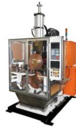
Máquina de soldadura por puntos de rodillos de 880kVA para el parachoques
