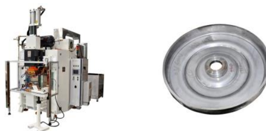
Soldadora por descarga de condensador de 60kJ para sistema de cambio de marchas de automóvil
